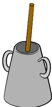
3. procedi a costipare il calcestruzzo nel cono (ad esempio, con 25 colpi eseguiti con un tondino di 16mm di diametro). Di seguito, riempi per un altro terzo il cono e procedi alla costipazione. Ripeti di nuovo fino a riempire il cono
