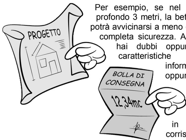
Per esempio, se nel cantiere hai uno scavo profondo 3 metri, la betoniera, o la pompa, non potrà avvicinarsi a meno di tre metri per operare in completa sicurezza. Anche in questo caso, se hai dubbi oppure il tuo cantiere ha caratteristiche particolari, chiedi informazioni al direttore lavori oppure al coordinatore per la sicurezza.
